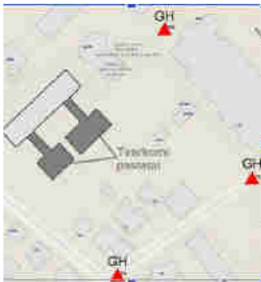
Pav. 1. Esami hidrantai (GH) gaistų gesinimui aplink pastatą
